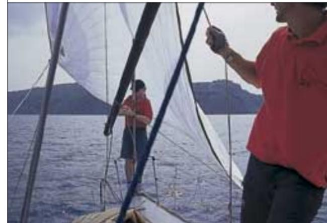
**Falsch:** Die Leeschot wurde am Beginn der Halse nicht ausreichend gefiert, daher wird der Spinnaker jetzt von Luv auf das Vordeck gedrückt. Wird jetzt unbeirrt weitergehalst, besteht die Gefahr, dass der Baum den Spi zerreißt.
