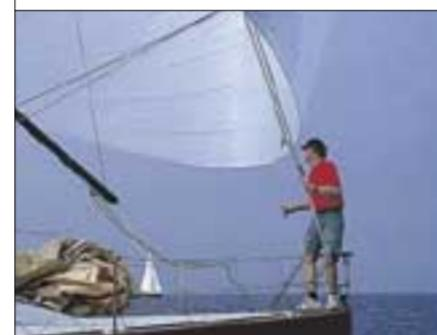
◀ Die Halse wird zu Ende gefahren. Der Spinnaker rotiert weiter ins neue Lee, der Spibaum in Luv nach achtern. Unbedingt darauf achten, dass der Baum – so wie auf diesem Bild – zuerst nach achtern geschwenkt und dann erst angehoben wird. Hebt man ihn gleich, kann er sich leicht im Spi verfangen und diesen beschädigen.
