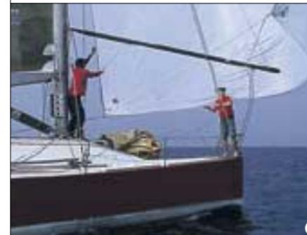
◀ Der Achterholer wurde bereits ausgeklinkt, der Spibaumschlitten bis zur Markierung hochgefahren und der Topnant gefiert. Der Mastmann führt den Baum eventuell unter zu Hilfenahme der Reißleine zum Bugmann. Dabei ist unbedingt darauf zu achten, dass sich der Spibaum zuerst nach unten und erst dann Richtung Bug bewegt. So kann er den Spi nicht beschädigen und die Verletzungsgefahr ist geringer.
